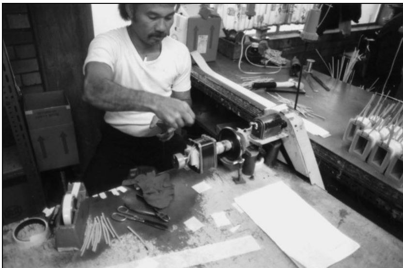
Abbildung 33: Manuelle Herstellung von elektromagnetischen Spulen für Transformatoren bei der Auckland Transformer Co. Ltd. in Neuseeland. Nach der Übernahme der Firma durch Atco Controls wurde die Produktion weitgehend automatisiert.
