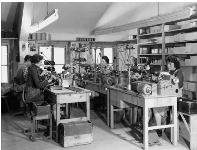
Abbildung 12: Wickeln von elektrischen Spulen für Vorschaltgeräte bei der Elektrogeräte und Kunstharzpresswerk W. Zumtobel KG in den frühen 1950er Jahren.
