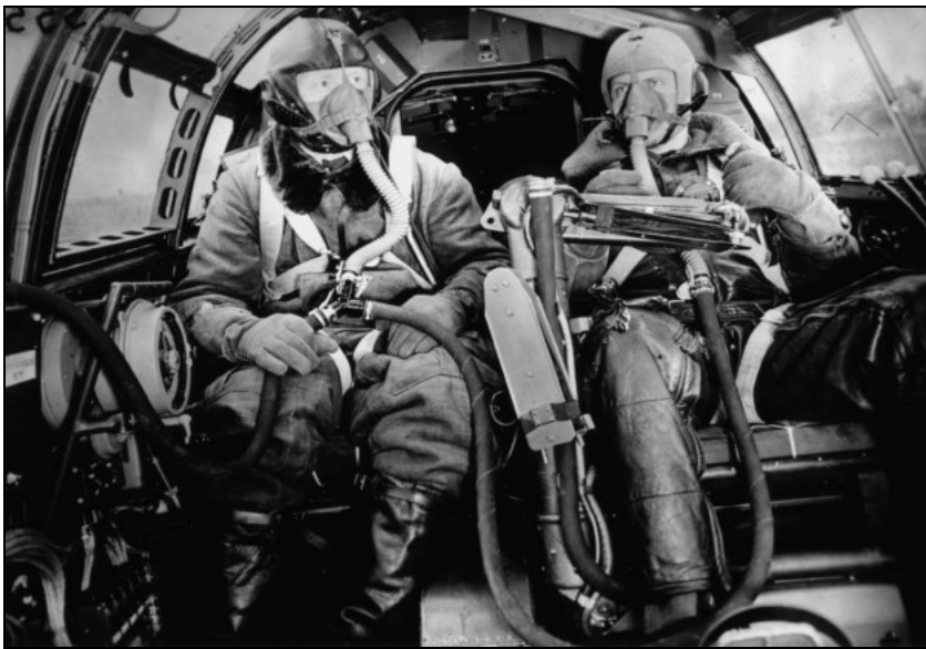
Abbildung 2: Zwei Flieger werden von einem Dräger-Höhenatmer mit Sauerstoff versorgt. Walter Zumtobel beschäftigt sich unter anderem mit der Konstruktion solcher Geräte.
