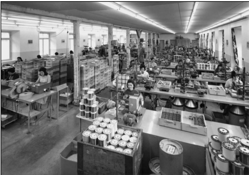
Abbildung 38: Die Herstellung von Vorschaltgeräten für Leuchtstofflampen am Stammsitz des Unternehmens Knobel im schweizerischen Ennenda, 1960er Jahre.
