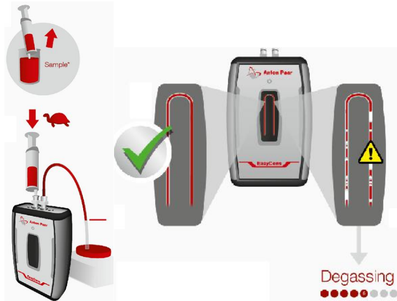
Abbildung 2: Befüllen des Gerätes mit der Probe (links), wobei keine Blasen in die Messzelle gelangen dürfen (rechts) (Abbildung der App „EasyDens“ unter dem Punkt Tutorial entnommen)
