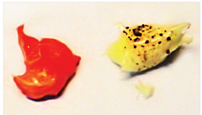
Abb. 1: Emulsionsanalyse mit roter Ostereierfarbe Links: Diätmargarine mit hohem Wasseranteil Rechts: Ceres® reines Palmfett
