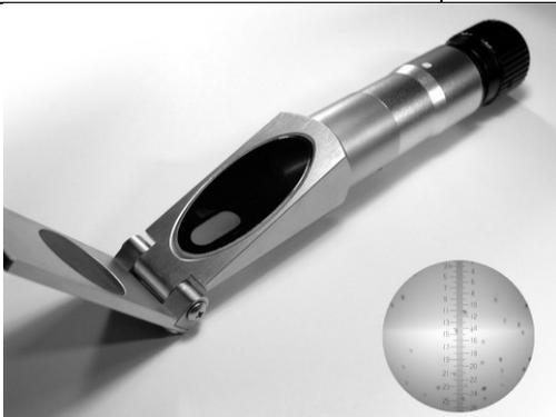
Abbildung 30: Refraktometer [59]
