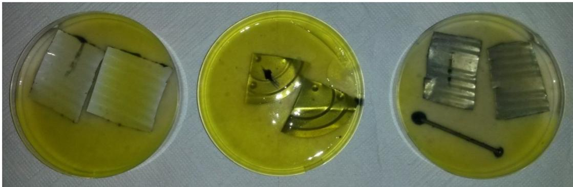
Abbildung 48: Nachweis der schützenden Wirkung der Beschichtung von Dosen - nach 3 Tag
