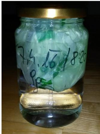
Abbildung 25: Lösungsversuch eines Biokunststoffes in Wasser
