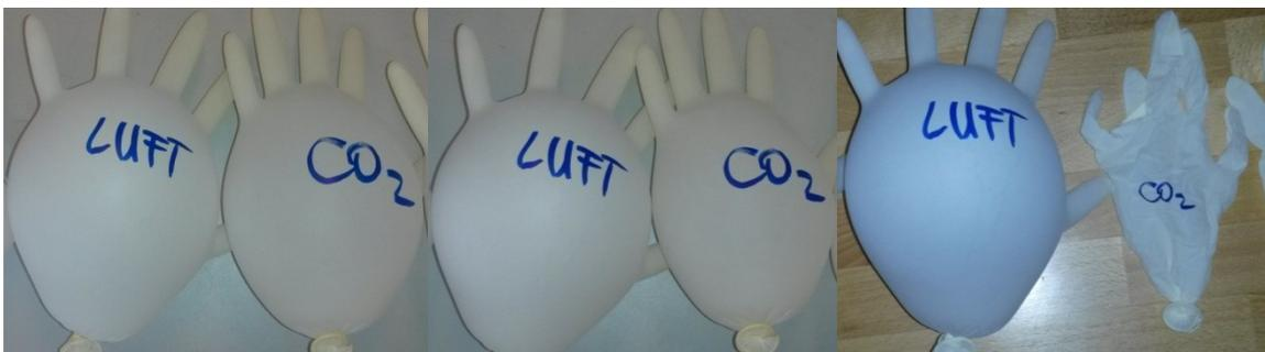
Abbildung 40: Latexhandschuh beim Start, nach einer 1/2 Stunden und nach 5 Stunden
