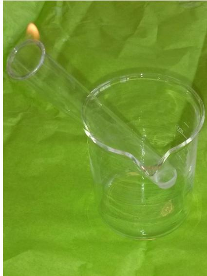
Abbildung 27: Nachweis der Brennbarkeit von Butan mit dem Reagenzglas
