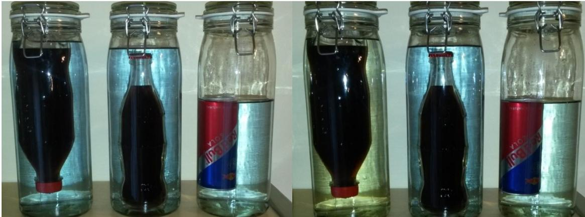
Abbildung 31: Beobachtungszeitraum Kunststoff-, Glas- und Metallgefäß - Start und nach ca. 21 Stunden
