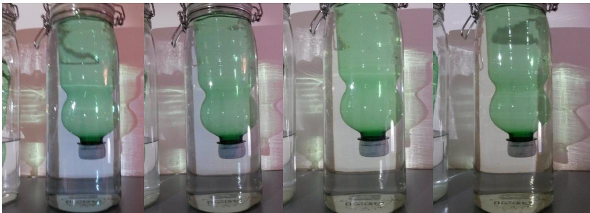
Abbildung 33: Beobachtungszeitraum Kunststoffgefäß - Start, nach 4 bzw. 8 Stunden und nach 3 Tagen
