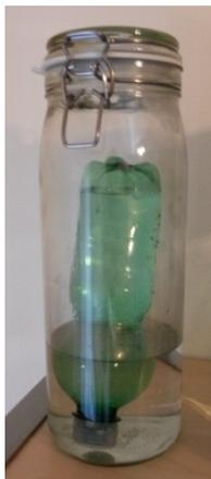
Abbildung 36: Versuchsaufbau zum Nachweis von Kohlenstoffdioxid mit Kalkwasser
