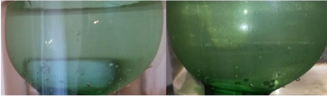
Abbildung 37: Start und die erkennbare Kalkablagerung nach ca. einem Tag
