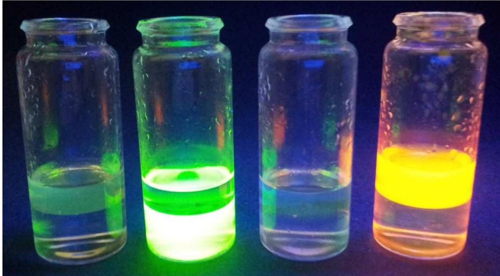
Abbildung 33. Fluoreszein und Phloxin in den entsprechenden Phasen unter der UV Lampe bei 340 nm
