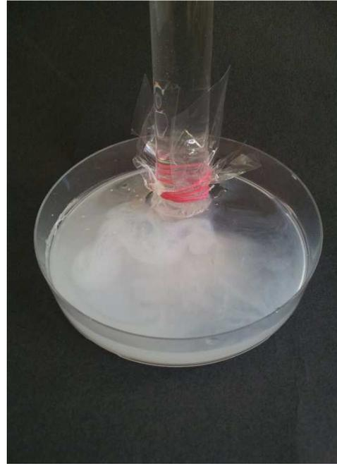
Abbildung 22. Nachweis der Permeation von Natriumchlorid durch die Chlorid-Reaktion mit  $\text{AgNO}_3$  zu  $\text{AgCl}$
