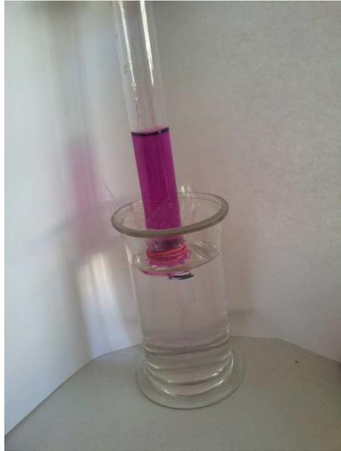
Abbildung 20.  $\text{KMnO}_4$  Teilchen durchdringen die Membran
