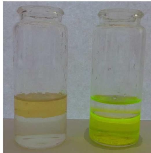
Abbildung 25. Fluoreszein gelöst in HCl (links) und NaOH (rechts) mit Octan-1-ol überschichtet
