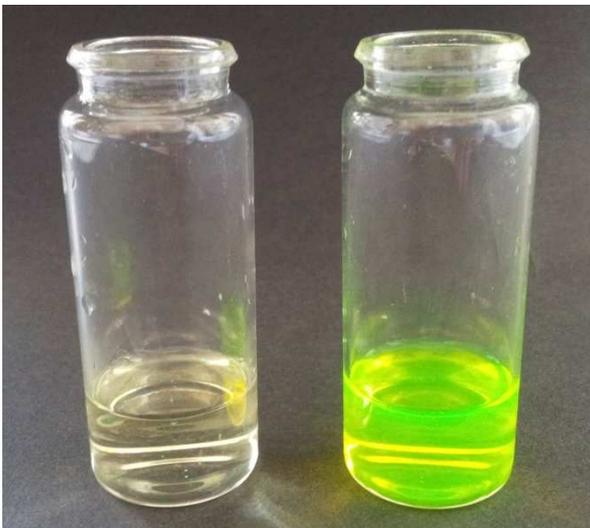
Abbildung 24. Fluoreszein gelöst in HCl (links) und NaOH (rechts)
