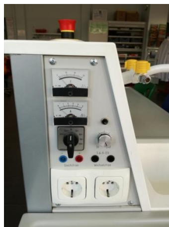
Abbildung 23 – Armatur eines Arbeitsplatzes für Lernende von der Seite, mit Anschlüssen für Gleich- und Wechselstrom. Foto: Böhm
