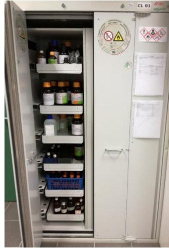
Abbildung 7 – Sicherheitsschrank Typ 90 geöffnet, mit Auffangwannen für Flüssigkeiten. Foto: Böhm
