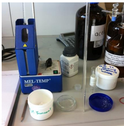
Abb. 15: MEL-TEMP –Gerät zur genauen Bestimmung des Schmelzpunktes
