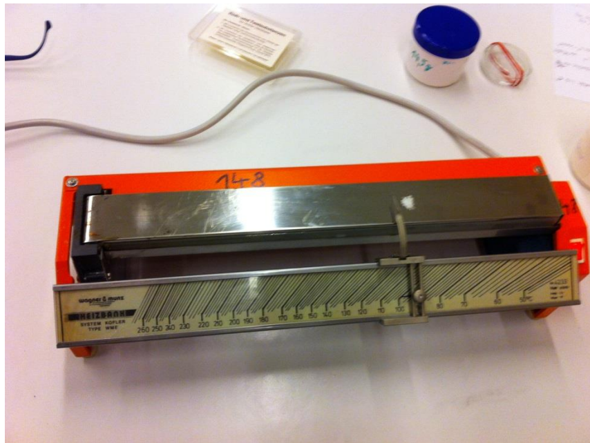
Abb. 14: Heizbank nach Kofler mit einer Probe des Dimethylfumarats
