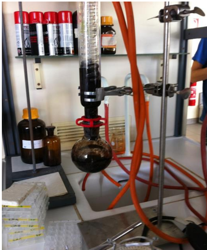
Abb. 8: Verunreinigtes Syntheseprodukt durch Reaktionen aufgrund der Überschreitung der Syntheszeit
