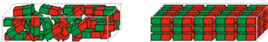
Abbildung 13: Elementarmagnetenmodell, links im unmagnetisierten, rechts im magnetisierten Zustand, übernommen von Leifi Physik (Internetquelle, siehe Literatur)
