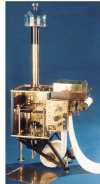
Das von Hans Benndorf 1909 entwickelte Vier-Quadranten-Elektrometer zeichnete in Wetterstationen die Luftelektrizität auf.
