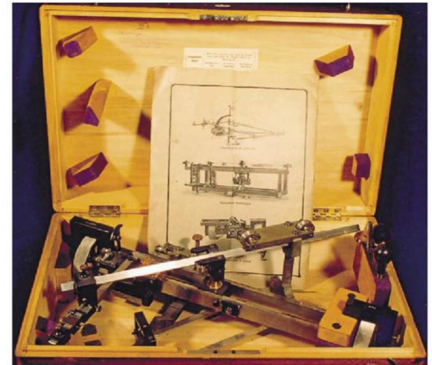
Der Integrator war in gewisser Weise ein Vorfahre des Computers. Man legte auf Papier aufgezeichnete Messpunkte ein und vervollständigte sie zu einer Kurve. Die Maschine konnte daraufhin durch numerische Integration automatisch die Fläche unter der Kurve bestimmen.
