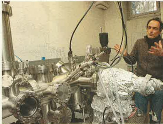
Physiker Michael Ramsey mit einer in der Werkstätte gefertigten Ultrahochvakuumanlage
