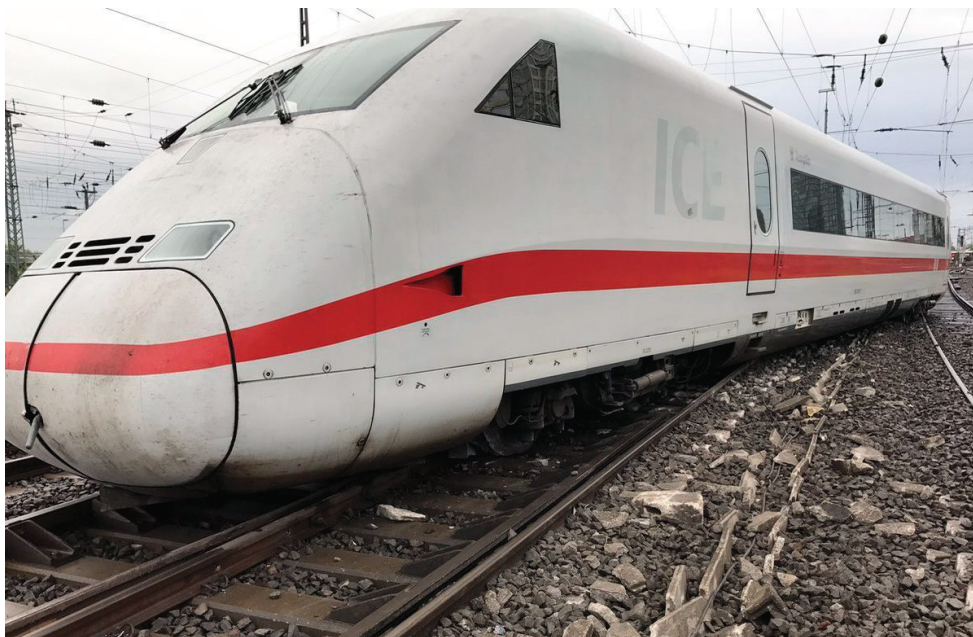
Aus noch unbekannter Ursache sind die letzten beiden Wagen des ICE aus dem Gleis gesprungen.
