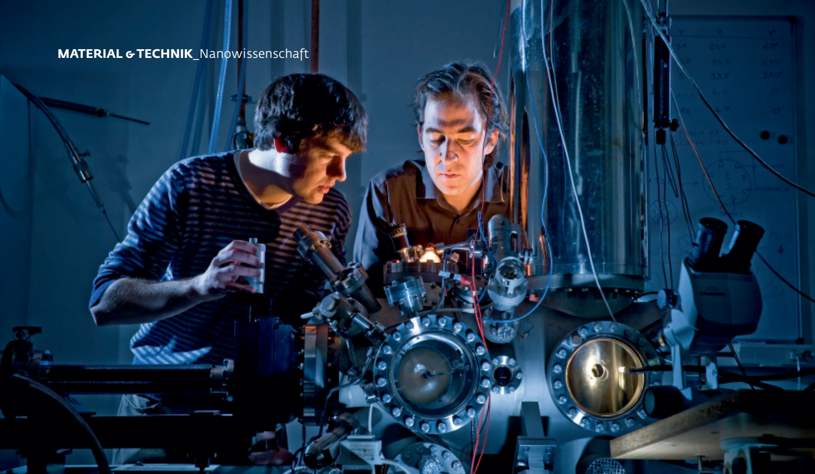
Eine Maschine, mit der Leonhard Grill (rechts) und sein Team Nanomaschinen untersuchen: Zusammen mit Alex Saywell überführt er eine Probe von der Präparationskammer in die Messposition der Ultrahochvakuumanlage. Dort inspizieren die Forscher die Probe etwa mit einem Rastertunnelmikroskop. Der mächtige Zylinder in der rechten Bildhälfte enthält den Kryostaten, mit dem die Probe gekühlt wird.
