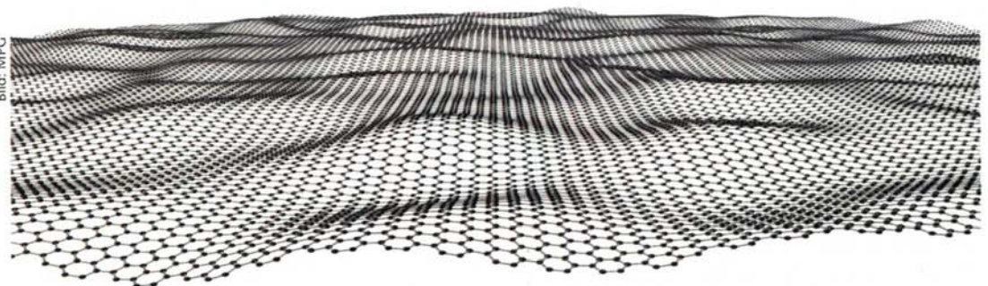
Das Modell einer Graphen-Membran - mit einer Dicke von nur einem Atom.
