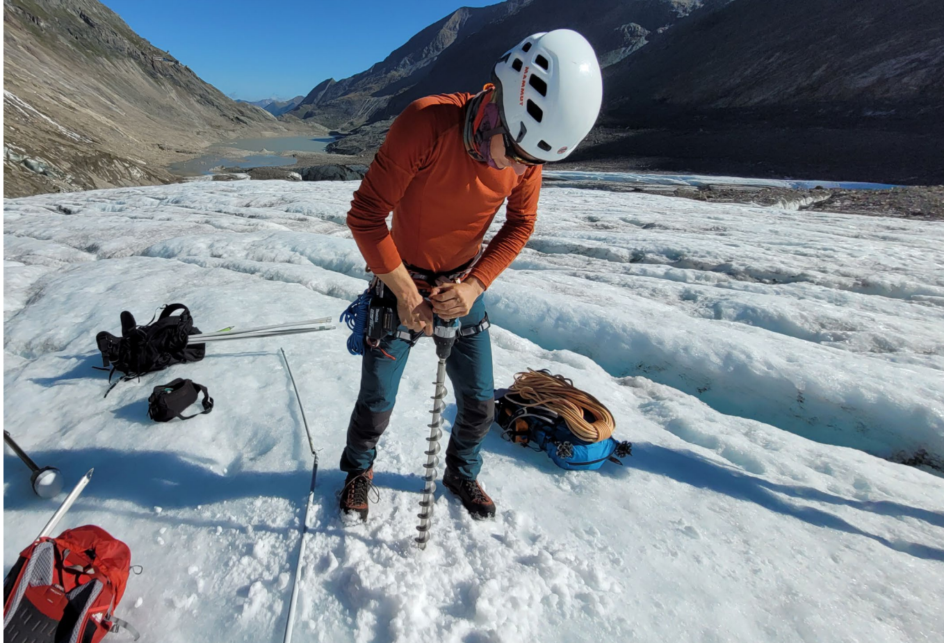
Foto: Bernhard Hynek 2023; Einbohren von Ablationspegeln an der Pasterze.
