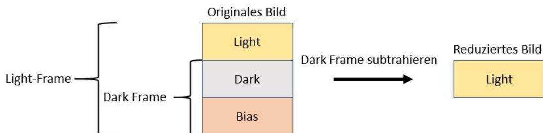
Abbildung 10: Einfacher Reduktionsprozess ohne Flatfield. Das Light (oder auch Science Frame genannt) wird reduziert, indem der Dark-Frame, bestehend aus Dark + Bias vom originalen Bild abgezogen wird.
